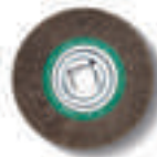
SPAZZOLA IN ACCIAIO Ø 250 mm x 60 mm, con un'elevata capacità di asportazione per un impiego estremamente redditizio, foro di attacco Ø 51 mm. Fili metallici con uno spessore di 0,2 mm per tubi e profilati dalle pareti sottili. Fili metallici con uno spessore di 0,35 mm per l'impiego universale. Fili metallici con uno spessore di 0,5 mm per tubi e profilati a parete spessa e per una potenza di sbavatura elevata. Versione in acciaio inox
