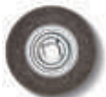
SPAZZOLA IN ACCIAIO Ø 250 mm x 60 mm, con un'elevata capacità di asportazione per un impiego estremamente redditizio, foro di attacco Ø 51 mm. Fili metallici con uno spessore di 0,2 mm per tubi e profilati dalle pareti sottili. Fili metallici con uno spessore di 0,35 mm per l'impiego universale. Fili metallici con uno spessore di 0,5 mm per tubi e profilati a parete spessa e per una potenza di sbavatura elevata. Versione in acciaio
