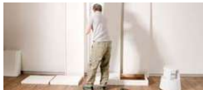
Posizionare la spalla terminale del mobile sul basamento. Il posizionamento del pezzo risulta molto facile grazie alle viti sporgenti.
