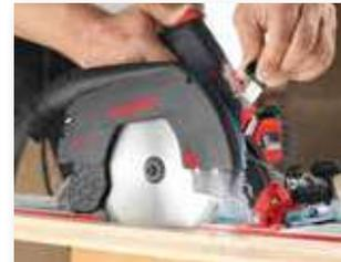
Il dispositivo FLIPPKEIL permette di realizzare tagli a immersione in maniera flessibile e sicura senza dover smontare il coltello divisorio.
