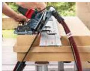
Per impostare il taglio inclinato la DSS 300 cc è dotata di una scala progressiva con regolazione fino a 60°. Successivamente potrete eseguire il taglio con l'appoggio aggiuntivo sulla o vicino alla barra guida.
