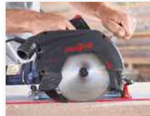
Il dispositivo FLIPKEIL permette di realizzare tagli a immersione in maniera flessibile e sicura senza dover smontare il coltello divisorio.
