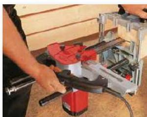
Con SG 230 mortasatura in verticale e in orizzontale.
