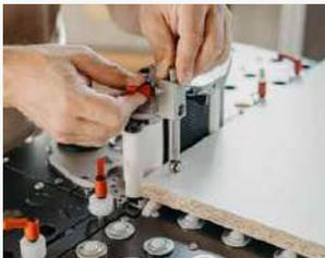
Per agevolare l'appoggio della tavola sui rulli a sfere del piano di lavoro di lavorazione BAT+, il dispositivo di fissaggio si può regolare opzionalmente all'altezza esatta della tavola.
