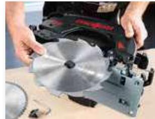
Co non impostazione possiamo bloccare la sicura e il motore per andare ad effettuare un cambio lama sicuro.
