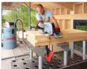
Dovete eseguire tagli longitudinali, trasversali oppure obliqui? Detto fatto con il banco da taglio, costituito da un sistema di elementi a incastro, la base ideale per tagliare materiale isolante rigido o morbido in ogni situazione di lavoro. Anche sul ponteggio.
