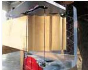
Grazie ai valori elevati della coppia, per la Z 5 Ec il taglio nel legno massiccio con una profondità di 305 mm è un gioco da ragazzi!.
