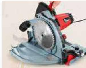
Con MAFELL il cambio della lama è più veloce che mai: premere il tasto di sbloccaggio e sollevare la leva. Aprire la cassa, cambiare la lama senza il rischio di danneggiare i denti della lama.
