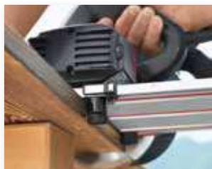
Grazie ad un perno fisso e ad un perno scorrevole possiamo regolare l'inclinazione di taglio da +50 a -60 gradi.
