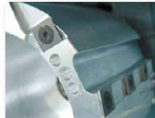
La nuova testa portafresa con le sue placchette ribaltabili in metallo duro comporta un'insuperabile capacità di truciolatura, migliorando nel contempo l'evacuazione dei trucioli.
