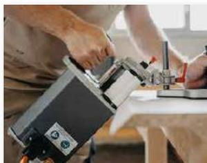
È possibile inclinare la piastra di appoggio fino a 50° per bordi di tavole inclinate.
