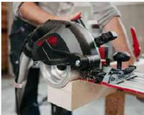
La potenza concentrata e la grande forza di trascinamento della NFU 50 consentono fresature di 60 mm di larghezza e 50 mm di profondità.
