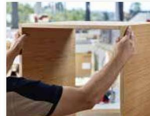
La collaudata tecnica a doppio foro impedisce che i pezzi in lavorazione si possano torcere l'uno contro l'altro dopo la giunzione. In questo modo si elimina la necessità di allineare i pezzi.
