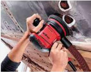
Per la sgrossatura l'EVA 150 E / 5 è l'utensile ideale. Grazie alla corsa oscillante di 5 mm e 12.000 g/min garantisce lavori perfetti.
