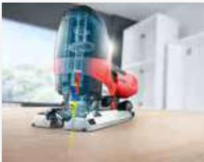
Nel sistema CUmax una molla esercita la pressione in senso verticale direttamente su un cuneo che provvede a fissare la lama nell'alloggiamento.
