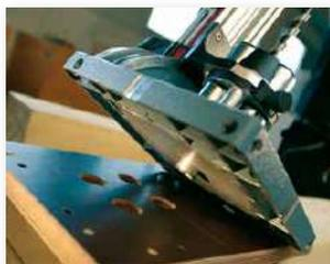
Per forature in serie e schemi di forature è possibile utilizzare, invece dell'inserto, un dispositivo di riproduzione: il sistema ideale per lavorare con maschere di foratura.
