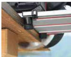
Grazie ad un perno fisso e ad un perno scorrevole possiamo regolare l'inclinazione di taglio da +50 a -60 gradi.
