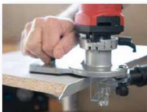
La grande superficie di appoggio consente una lavorazione in totale sicurezza anche di bordi inclinati.
