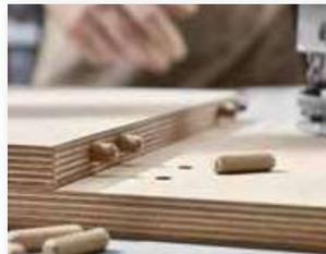
L'applicazione di fori a interasse di 32 mm fa parte della routine professionale. La spinatrice doppia DDF 40 può essere utilizzato anche per praticare serie di fori da 32 mm e fori di fissaggio – e quindi assemblare mobili completi.
