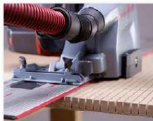
Grazie al dispositivo MF-SE 3 è facile realizzare fessure, tre in un unico passaggio, ad esempio per realizzare elementi curvi in modo rapido e facile.
