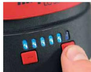
Il MAFELL IPC è la nuova elettronica digitale. È dotato di una tecnologia di controllo per la protezione dal riavvio, con protezione dal sovraccarico e numero di giri costante sotto carico. I LED colorati forniscono informazioni sulle funzioni e sugli stati operativi.
