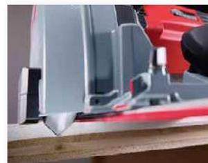
Con la fresatrice MF-GF 90/15 si possono realizzare scanalature a V con angoli da 90° senza produrre tanto pulviscolo, impiegando successivamente della colla basta poco tempo per avere unioni ad angolo solide.
