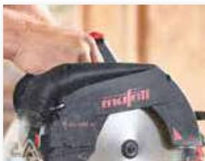
Il sistema di rimozione dei trucioli è stato ottimizzato per il taglio di pannelli in fibra di legno. Anche nel caso di tagli a immersione lungo la direzione delle fibre il nuovo sistema per la rimozione dei trucioli è molto vantaggioso.
