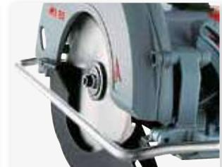
Lo stabile arco in metallo massiccio funge da supporto ausiliario e da protezione per macchina ed operatore.
