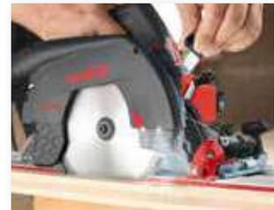
Il dispositivo FLIPPKEIL permette di realizzare tagli a immersione in maniera flessibile e sicura senza dover smontare il coltello divisore.
