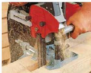
La LS 103 Ec con sistema di squadre FG 150 per perforazioni fino a 150 mm.
