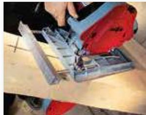
Un dispositivo di soffiaggio permette di mantenere sempre la tracciatura pulita.
