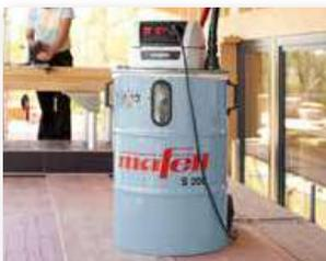
Durante la lavorazione di materiale isolante in fibra di legno viene prodotta una grande quantità di trucioli e polvere. L'aspiratore S 200 elimina il 90% del volume senza problemi.
