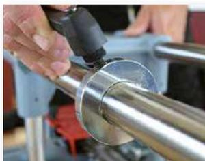
È possibile regolare esattamente la distanza verticale dal bordo tramite una scala.
