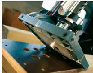
Per forature in serie e schemi di forature è possibile utilizzare, invece dell'inserto, un dispositivo di riproduzione: il sistema ideale per lavorare con maschere di foratura.
