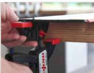
Le guide a binario vengono fissate anche al pezzo di lavorazione mediante 2 morsetti.
