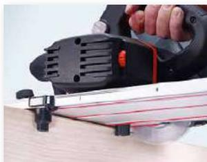
Sulla parte inferiore della guida sono presenti le battute che permettono di impostare l'angolazione secondo la scala. Al termine del passaggio di lavorazione una molla farà sì che la fresatrice ritorni alla posizione iniziale.
