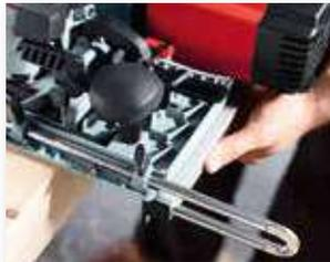
Grazie alla battuta di riscontro posso con la scala graduata lavorare con una precisione millimetrica.
