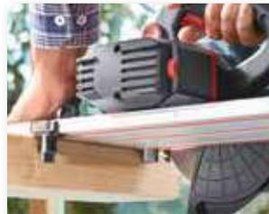
Grazie ad un perno fisso e ad un perno scorrevole possiamo regolare l'inclinazione di taglio da +60 a -60 gradi.
