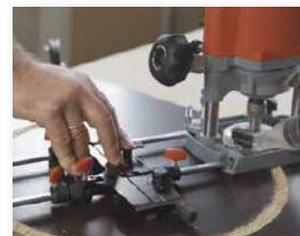
Dispositivo di guida per fresatrice verticale Mafell LO-FA può essere utilizzato come fermo per tasche di fresatura, adattatore per binari di guida, recinzione di strappo o bussola.
