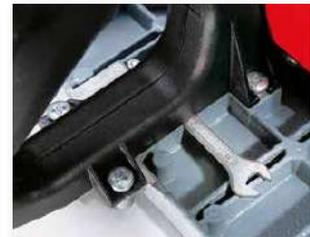
La chiave per la sostituzione dei coltelli è alloggiata direttamente nella macchina.
