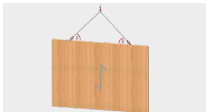
Parete o supporto BSH verticale, fibratura: verticale
