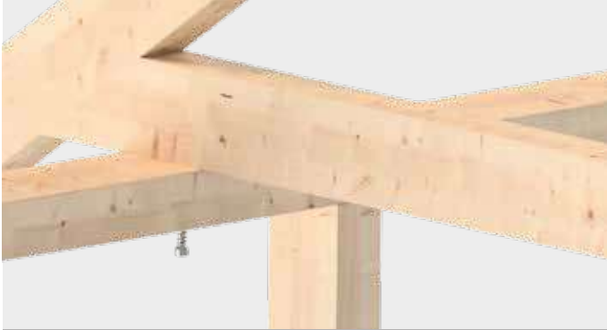
Fissaggio di traverse per costruzioni leggere a telaio in legno
