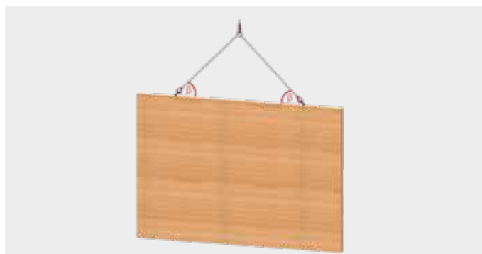
Parete o supporto BSH verticale, fibratura: verticale
