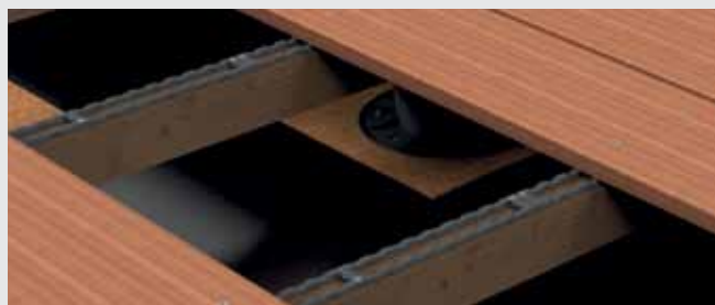
Con l'impiego del listello Dista 2.0 si evita la tranciatura delle viti.
