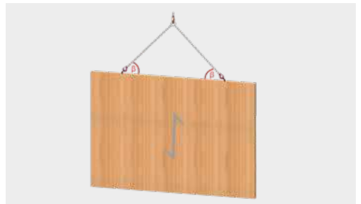
Parete o supporto BSH verticale, fibratura: verticale
