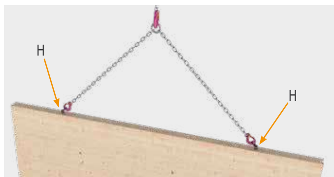
Sollevamento di una parete verticale con due ancoraggi di sollevamento Mini montati e bulloni di supporto sferici (H) sul lato stretto.
