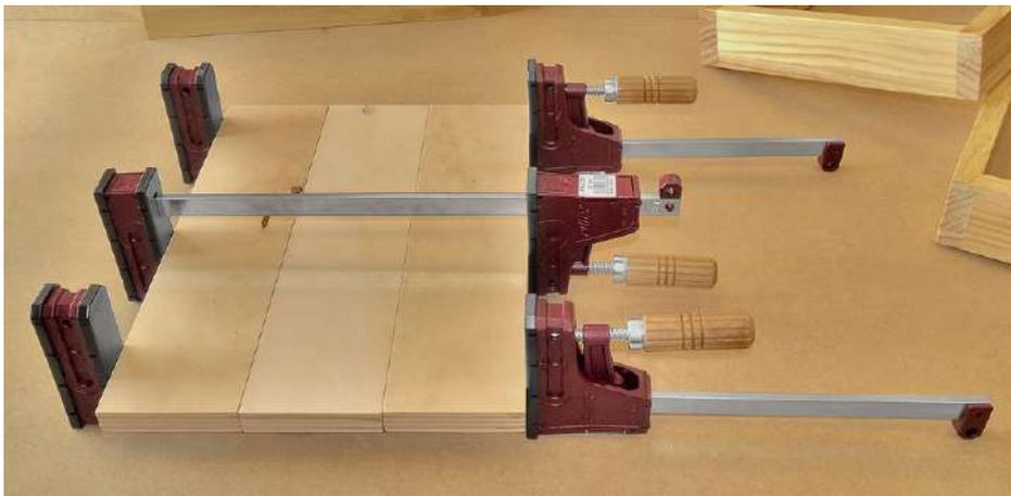
7 alberi in acciaio per mantenere le ganasce parallele e la barra allineata
