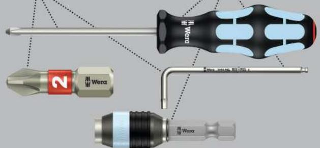
Inseri di alta qualità in acciaio inox per viti a croce. Gli utensili della Wera in acciaio inox sono realizzati in acciaio inox per evitare la formazione di ruggine impropria. Con zona di torsione: con gli inserti a torsione che, durante i picchi di carico, assorbono l'energia cinetica. Si evita così l'usura precoce dell'inserto, prolungandone la durata. Esagonale da 1/4", per porta-inseri secondo DIN ISO 1173-D 6,3.
