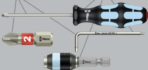
Inserti di alta qualità in acciaio inox per viti ad esagono cavo. Gli utensili della Wera in acciaio inox sono realizzati in acciaio inox per evitare la formazione di ruggine impropria. Il profilo Hex-Plus offre una maggiore superficie d'appoggio nella testa della vite, riducendo al minimo l'effetto d'intaglio e quindi eliminando quasi totalmente il rischio che la testa della vite si rompa. Esagonale da 1/4", per porta-inserti secondo DIN ISO 1173-D 6,3.
