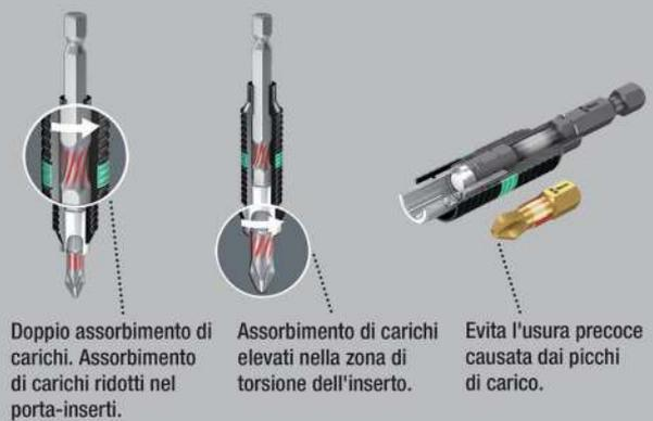
Porta-inserti universale per inserti esagonali da 1/4" secondo DIN ISO 1173-C 6,3 e E 6,3 (ISO 1173). I porta-inserti universali BiTorsion della Wera hanno una molla di torsione, che assorbe i picchi di carico ridotti durante gli avvitiamenti. L'uso insieme agli inserti BiTorsion con le loro zone di torsione fa sì che l'utensile duri più a lungo.
